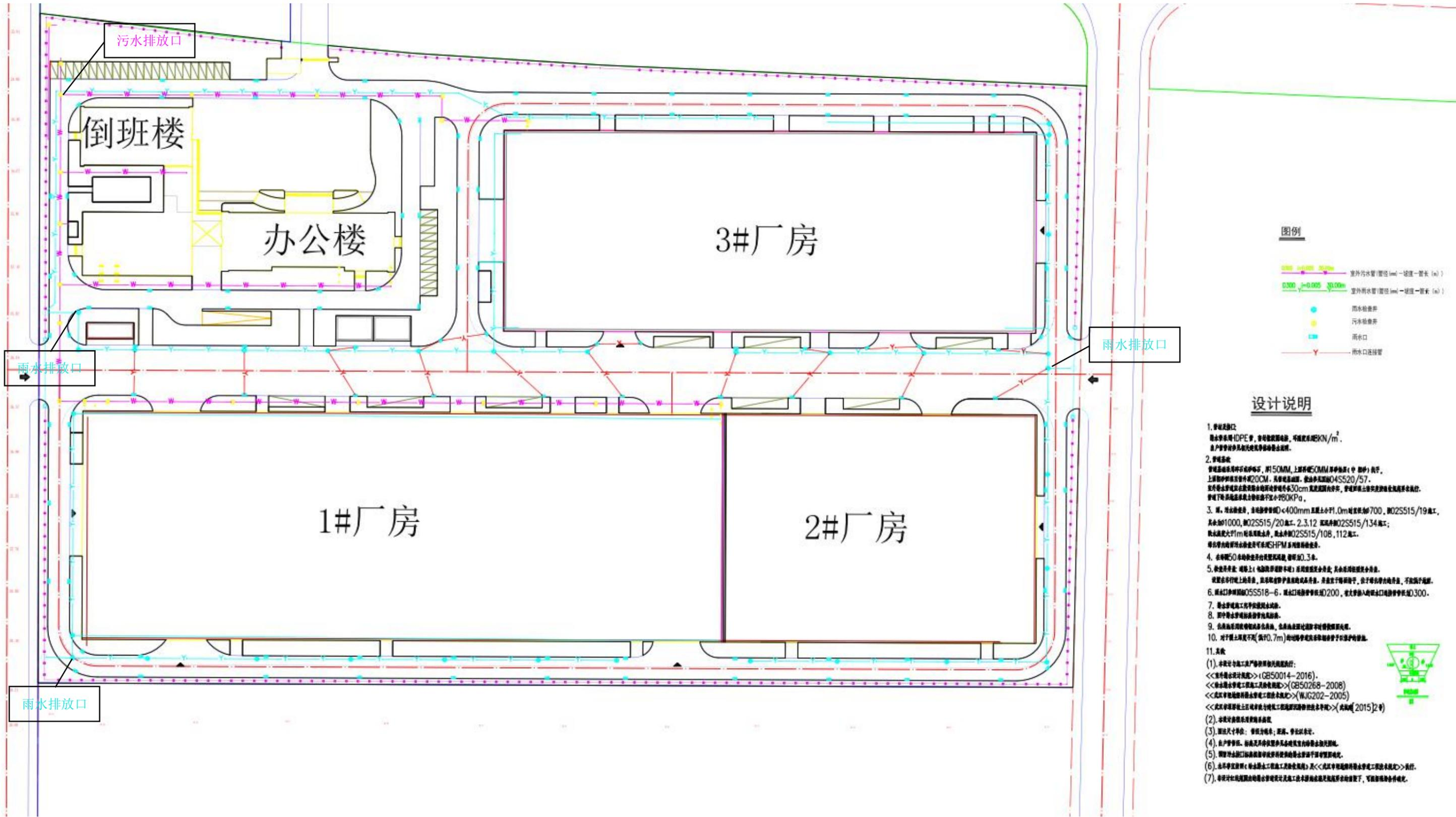
附图 4 厂区雨污水管网图
